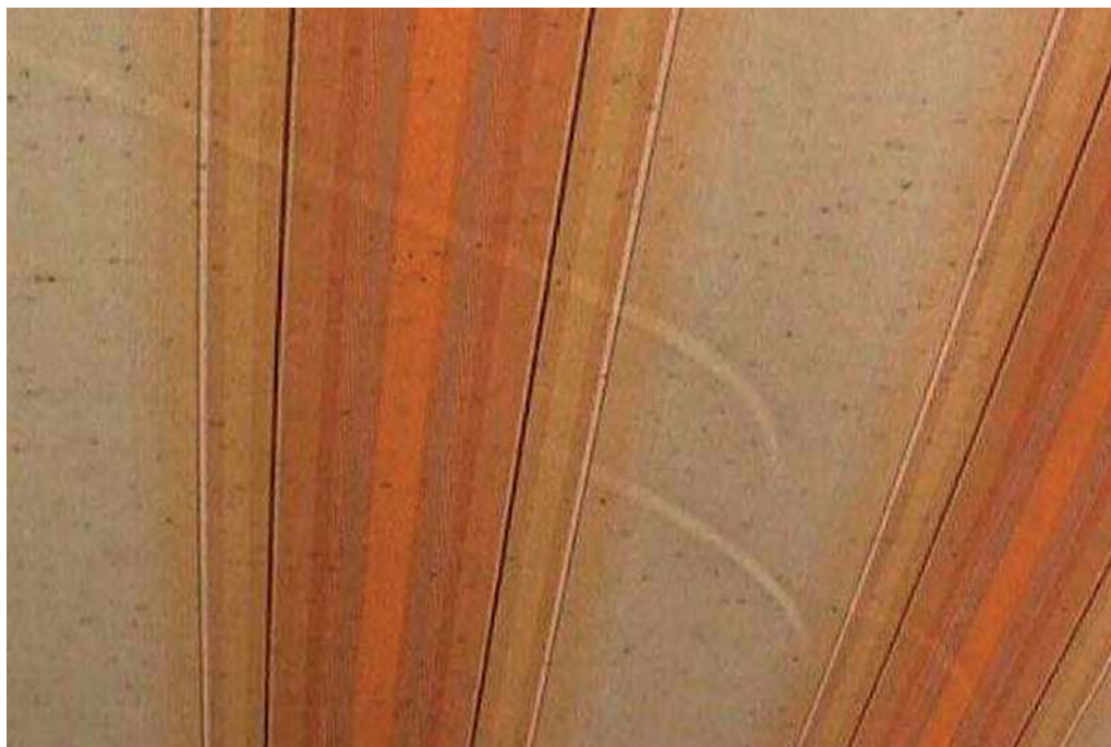
Bild 9.1.13 Darstellung von Überlagerung von Wickelfalten
