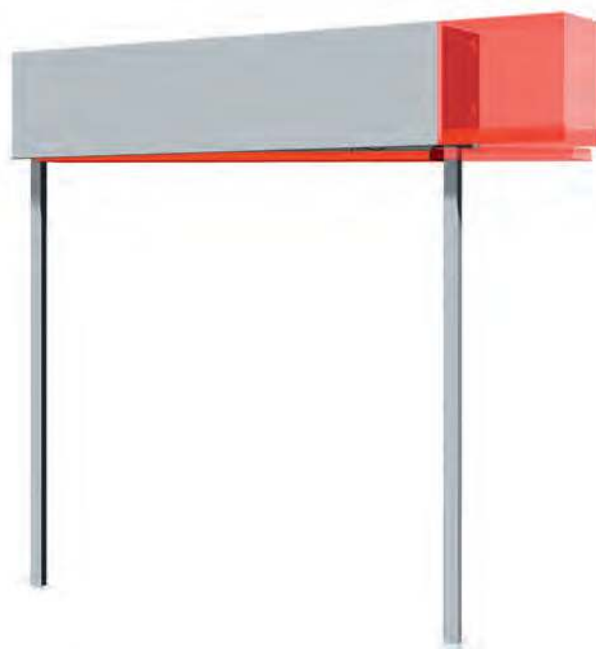
Bild 11: Veränderte Endlagenposition der Unterschiene (Unterschiene schief), Lamellenpaket einseitig sichtbar
