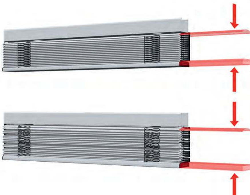
Bild 8: Unterschiedliche Lamellenpakethöhen durch erhöhten Paketaufbau (Unterschiede gerade)
