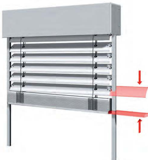
Bild 7: Schräglauf der Unterschiene (bei parallelem Lamellenpaket)
