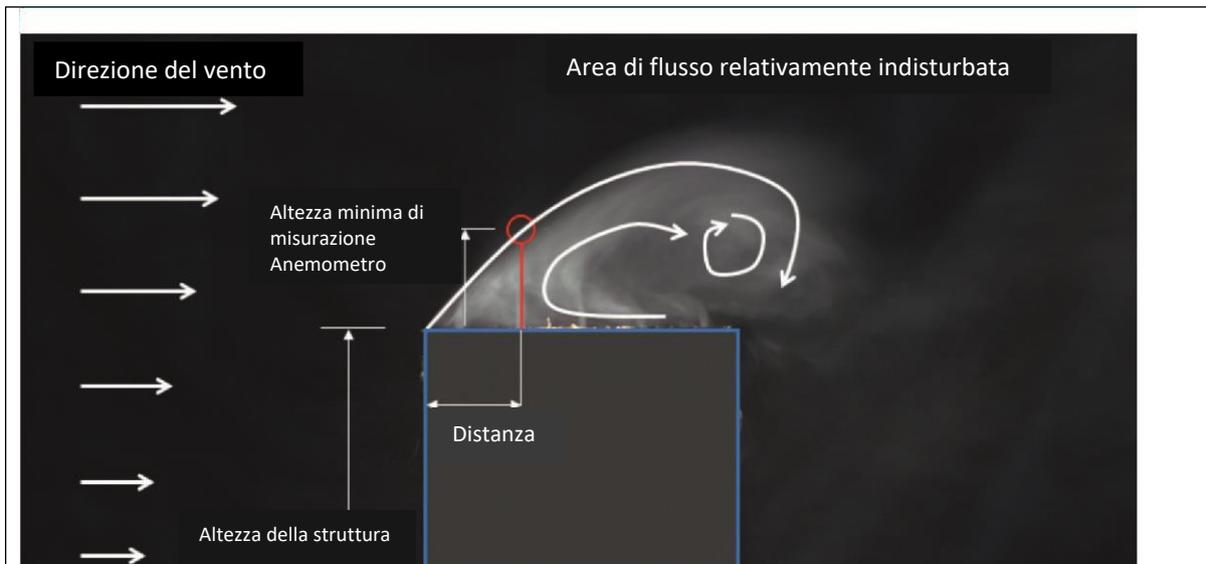
Figura 7: visualizzazione della corrente al di sopra dell'edificio nella galleria del vento, con altezza di rilevazione necessaria per l'anemometro. (Fonte: «Linee guida per l'utilizzo di anemometri», IVRSA)
