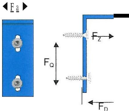
**Pose de supports sur châssis de fenêtre pour Stores à lamelles et Stores verticaux**
