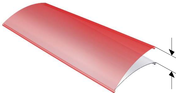
Image 15: Torsion dans l'axe de la lame
