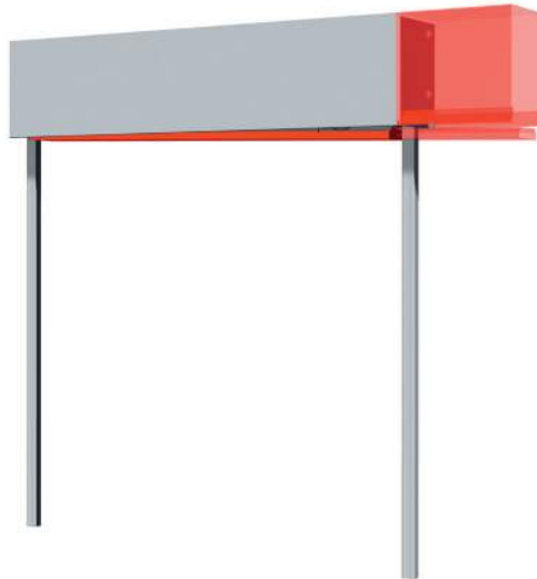
Image 16 : Position de lame finale modifiée (lame finale non horizontale), paquet de lames visible d'un côté
