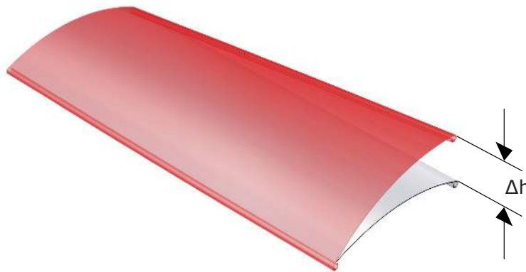
Image 18 : Torsion dans l'axe de la lame
