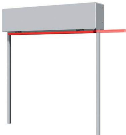
Image 17 : Position de la lame finale modifiée (lame finale horizontale), paquet de lames visible sur toute la largeur
