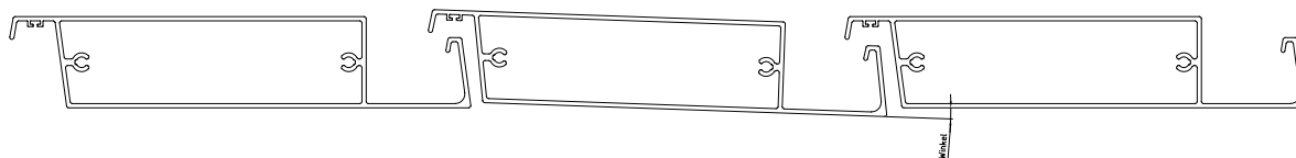
Abbildung 18: Toleranzen in der Lamellenstellung
